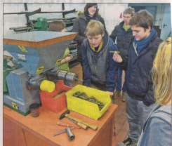
Skeptische Blicke auf ein Stück Rapskuchen, das die Ölpresse von sich gab. Das Rapsöl tropfte in die rote Schale.
